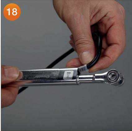
9. Repositionnez la protection plastique du câble, retirée précédemment, dans le bras du luminaire (Image 18).
