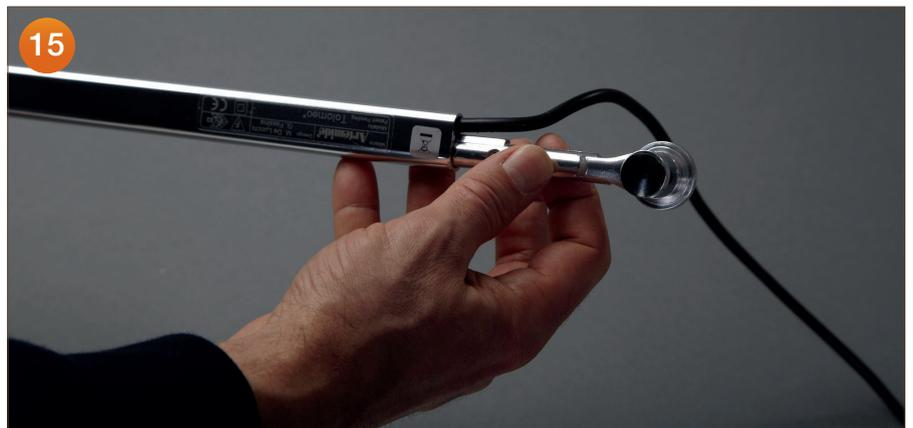
8. Pour la fixation de la nouvelle articulation dans le bras de lampe, vous devrez vous munir d'un gros tournevis, d'un marteau et d'un peu d'habileté. Placez le gros tournevis au bout de l'articulation entre les appendices troués. Par des coups légers, en agissant avec précaution, sur le manche du tournevis, engagez l'articulation dans le bras en aluminium. Il est également recommandé pour cette action de procéder à deux (Image 16-17).
